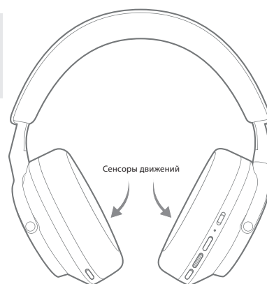
Diagram 3 Расположение сенсоров приближения
