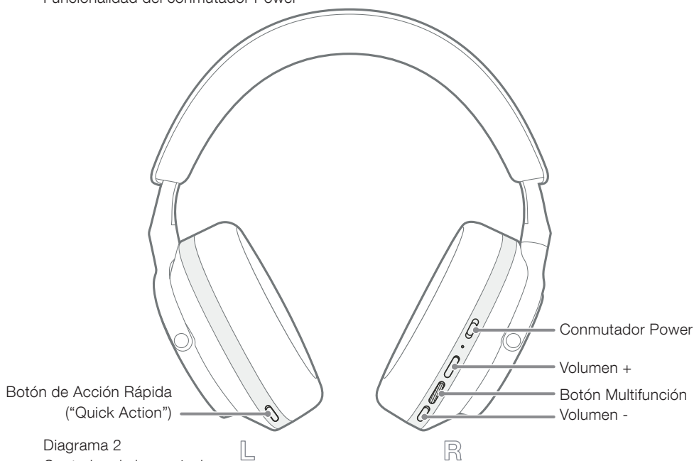
Diagrama 1 Funcionalidad del conmutador Power
